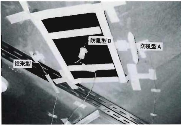
写真1 天井への各種マイクの設置状況
