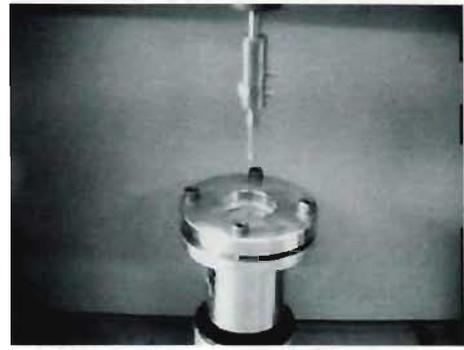
写真 1-4 突き刺し試験の状況
