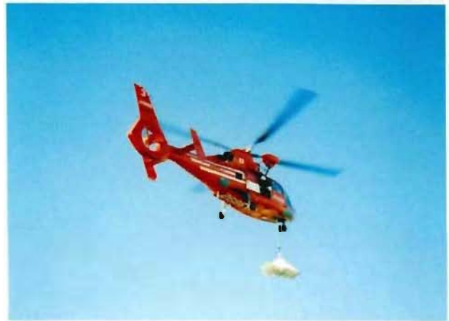
写真2 ダウンウォッシュによる荷重の測定状況
