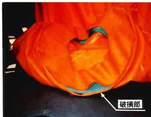
写真7 実験中に破損した逆止弁型水槽底部
