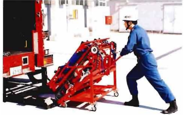
車両積載の操作状況
