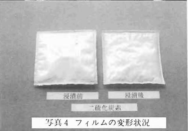
写真4 フィルムの変形状況
