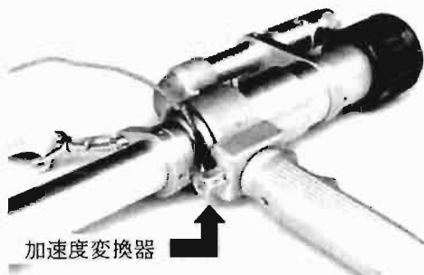
写真4 加速度変換器取付け状況
