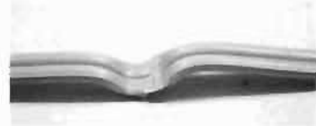
写真13 試験体1(横置き)の状況(荷重10kg)
