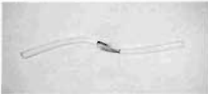
写真6 試験体3の引張試験後の状況
