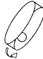
図7 金属球を封入したセンサー
