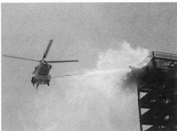
写真1 空中消火の放水状況
