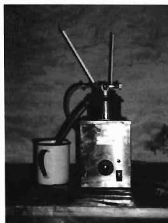
写真2 タグ密閉式引火点測定器
