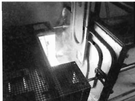
写真2 輻射熱に対する防護性能試験
