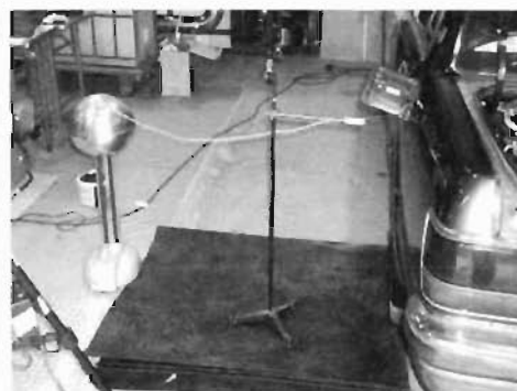
写真2 放電電極の設置状況
