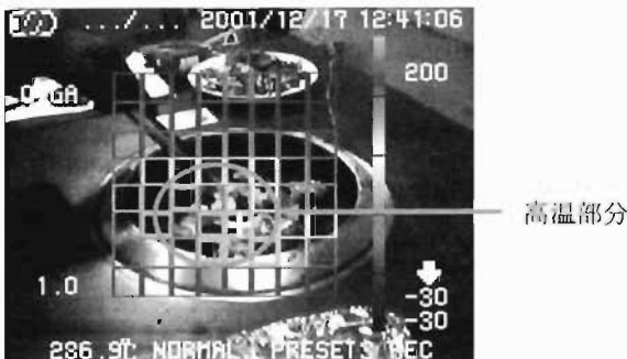
写真3 トップリングの温度分布
