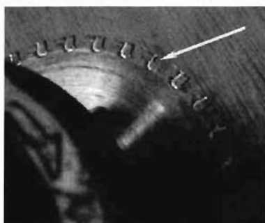
写真31 チップの欠け
