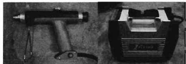
写真3 プラズマ金属加工機(左: トーチ、右: 電源部)
