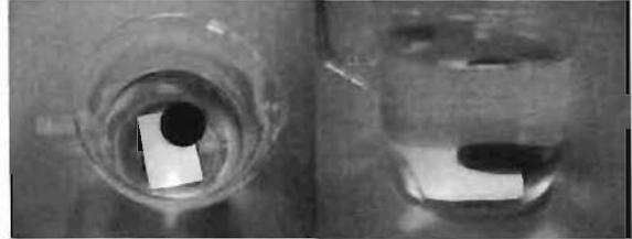
写真17 ビーカー内の水に浸したICタグ
