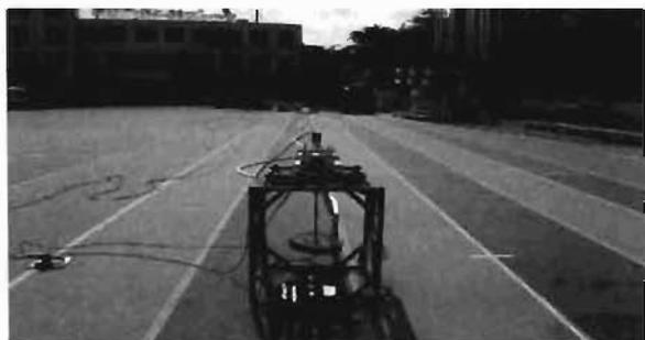
写真1 ノズル保持力測定実験①設定状況
