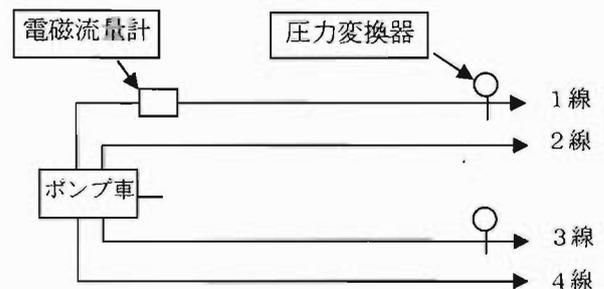
図1 4線延長隊形実験設定
