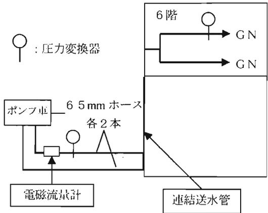
図4 2線延長隊形 (連結送水管活用) 実験設定
