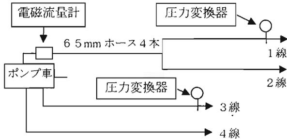
図2 4線延長隊形 (分岐あり) 実験設定
