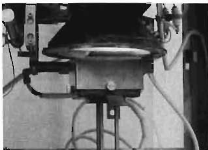
写真4 コーンカロリメーターによる実験状況
