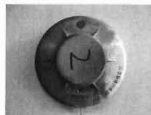
写真17 実験後のD室内住警器（煙式）
