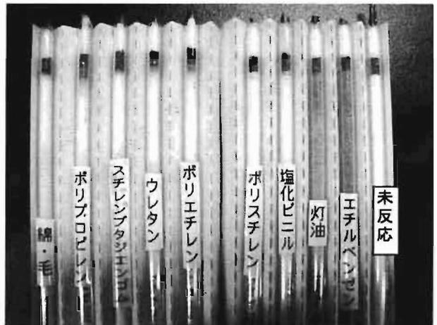
写真 4 検知管の反応状況
