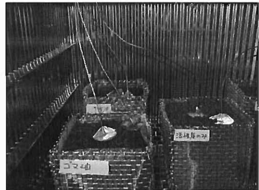
図3 恒温槽内における熱電対設置状況
