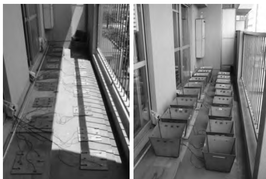
写真3 荷重変換器及び採水枘の配置状況
