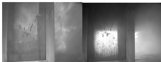
写真6 片開きドア開放後の爆発的燃焼とその後の一斉着火
