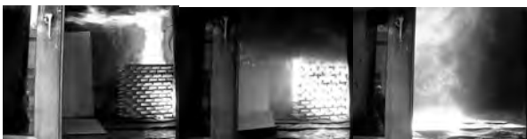
点火後 30秒 2分00秒 3分30秒 写真2 各可燃物の燃焼がリレーする様子
