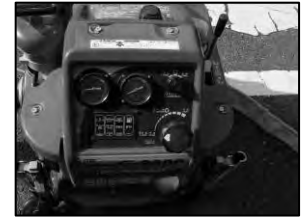
写真8 B-2級可搬消防ポンプ
