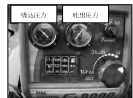
写真17 吸込・吐出圧力
