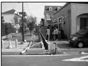
写真5 呼称65ホース延長状況
