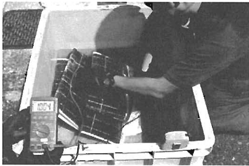
写真5 太陽光パネルの開放電圧測定 (乾燥状態)
