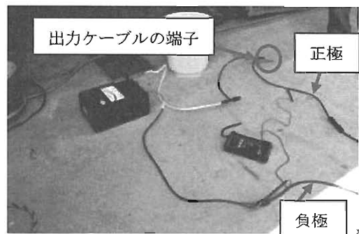
写真9 実験設定 (配線部)
