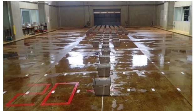
写真6 直状放水の採水枡設定状況
