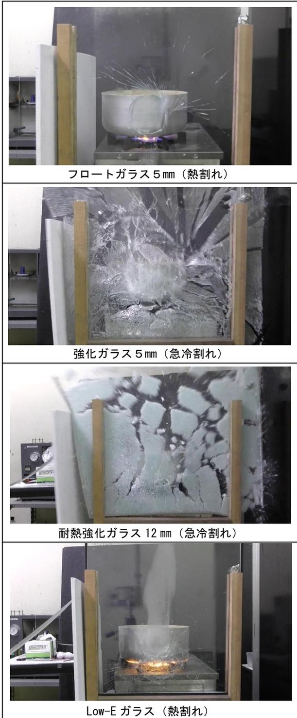
図6 ガラス熱割れ及び急冷割れ
