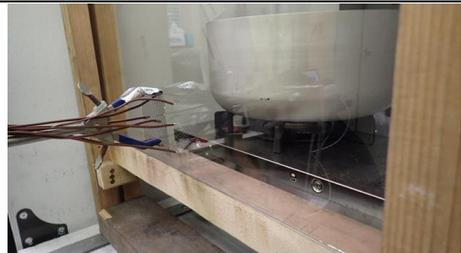
熱電対による非加熱面温度測定状況
