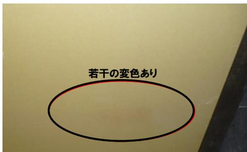
図7 加熱検証後の石膏ボード仕上げ状況 (離隔距離 3 cm)
