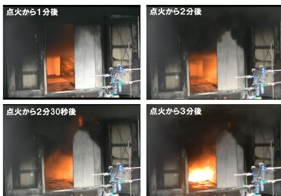
図11 実験①の燃焼状況
