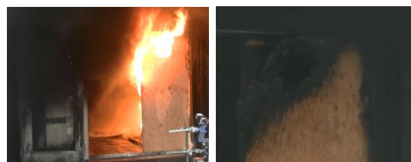
図13 実験②の壁材（合板）燃焼状況 （左図：点火3分後、右図：消火後）
