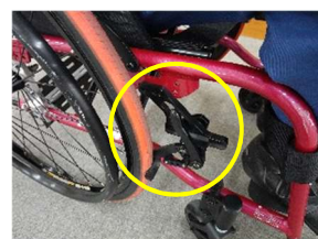
写真 4 ブレーキ作動時の状況
