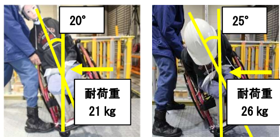
写真 14 起き姿勢時(左)と伏せ姿勢時(右)の回転開始角度及び耐荷重
