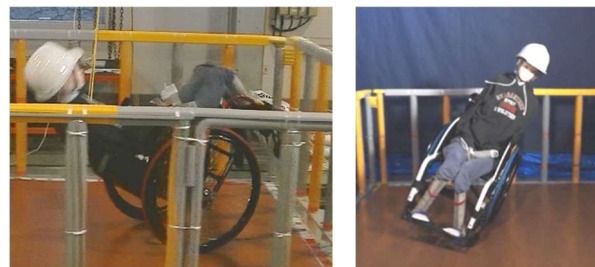
写真11 平行振動時(左)、垂直振動時(右)での転倒の状況
