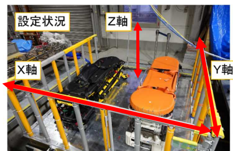
写真 4 各ストレッチャーの振動発生装置上の設定状況
