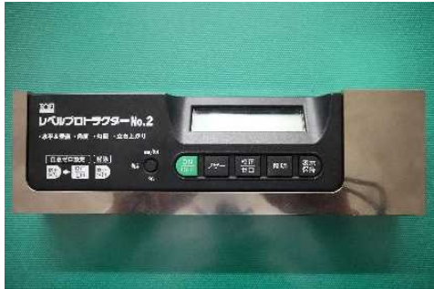
写真7 角度計の外観
