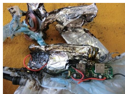
写真3 燃えた充電式電池
