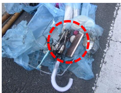
写真2 荷箱内の燃えたごみ
