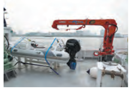
▲ 搭載艇及びクレーン装置 小型搭載艇を整備
