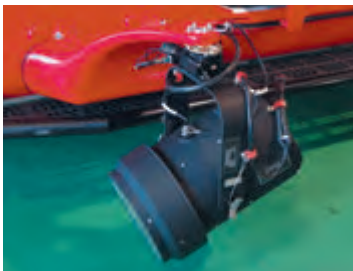
▲ 照明装置 (サーチライト) 照射出力 1,600W
