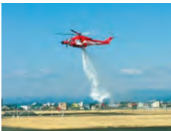
▲ 胴体下部取付け式消火装置 (ファイアーアタッカー) 容量 1,813L
