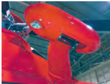
▲ 照明付き救助用ウィンチ装置 (ホイスト) ケーブル長 90m 最大荷重 272kg
