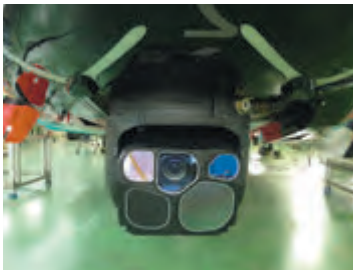
▲ 防振カメラ装置 (可視線、赤外線) 光学式 40 倍ズーム
