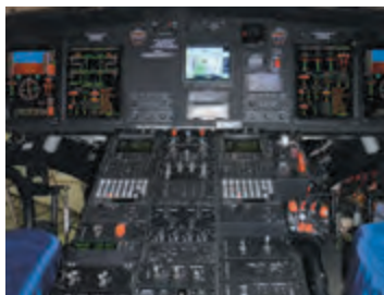
▲ グラスコックピット 自動操縦装置操作パネル 及び各種装置制御パネル
