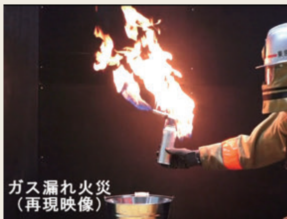
▲ ガストーチバーナーに起因した火災の再現実験
