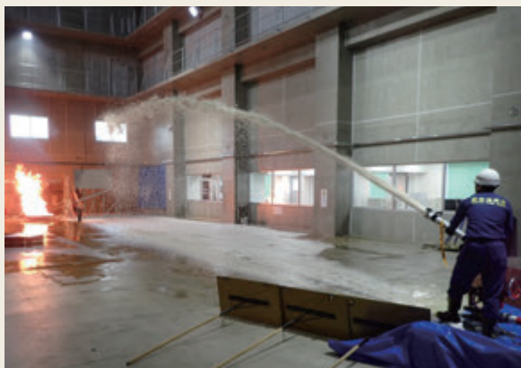
▲ 発泡器具の発泡性能、消火性能の検証
