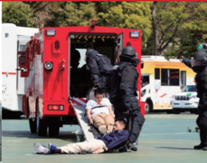
▲要救助者を収容するための電動展開式スロープ
