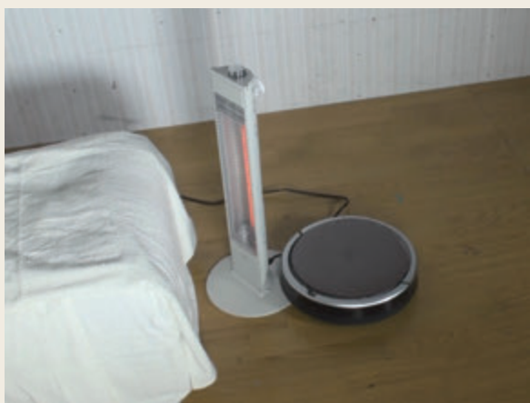
▲ ロボット掃除機に起因した火災の再現実験
