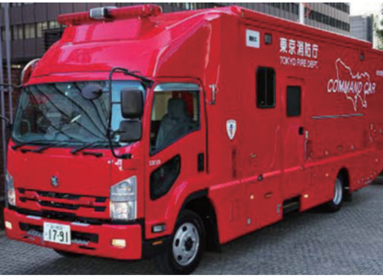
▲指揮統制車 (コマンドカー) 拡幅により現場指揮本部としての拠点スペースを確保
