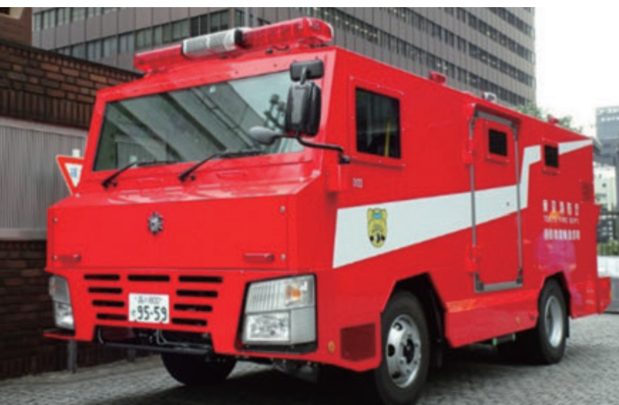
▲救出救助車（高機動、特殊防護型） 大規模災害が発生した現場付近の要救助者を迅速に救助するための車両
