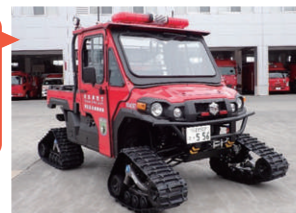
クローラー装着状況
