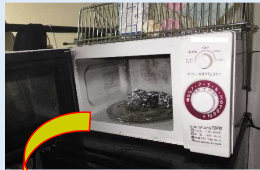
アルミホイルの加熱による火災事例
