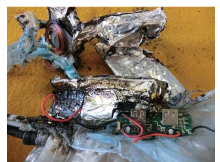
写真 1-3 潰れて燃えた充電式電池
