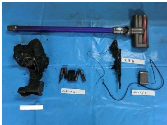
写真 2-1 焼損した掃除機の状況
