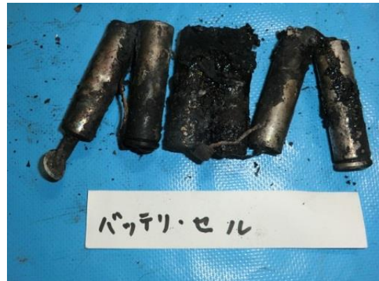
写真 2-2 焼損したバッテリーパック
