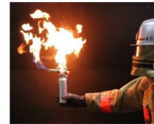
傾け過ぎたため異常燃焼! ガス漏れで消火不能に!
