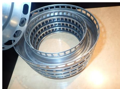
写真 5 - 5 店舗 A グリスフィルター
