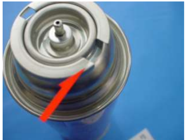
写真 2-2 燃料ボンベの切り込み凹部の状況
