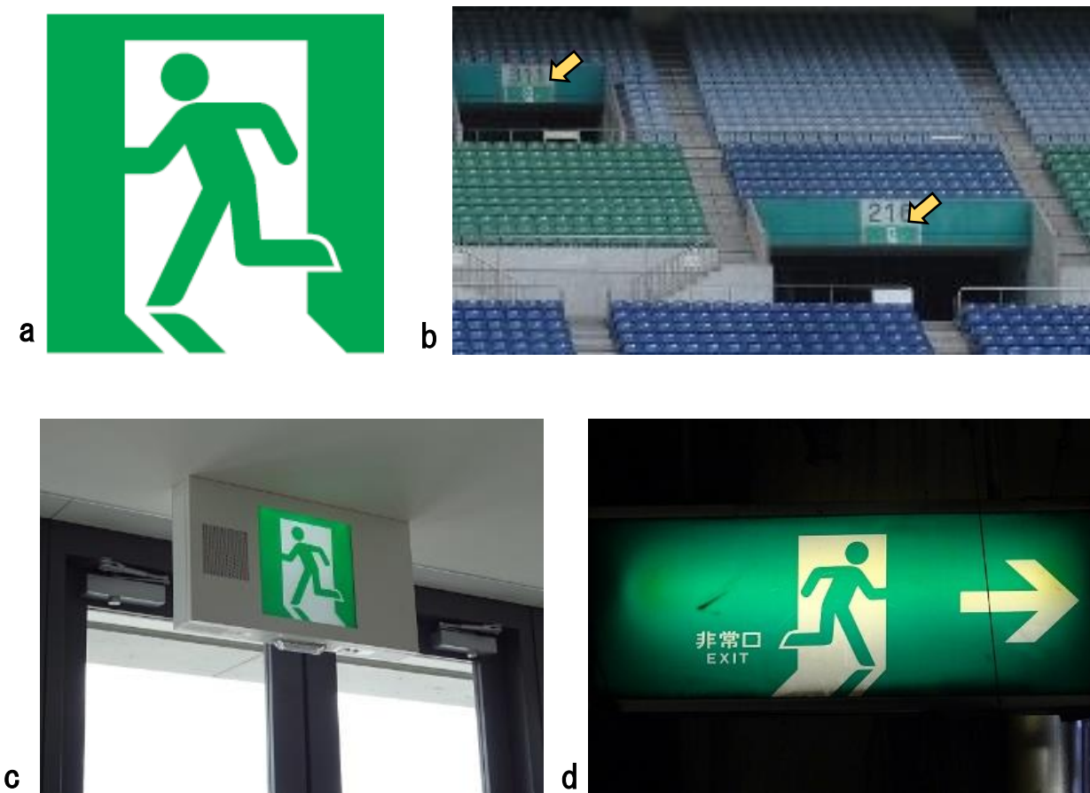
図5-2-1 避難口誘導灯国内使用例
