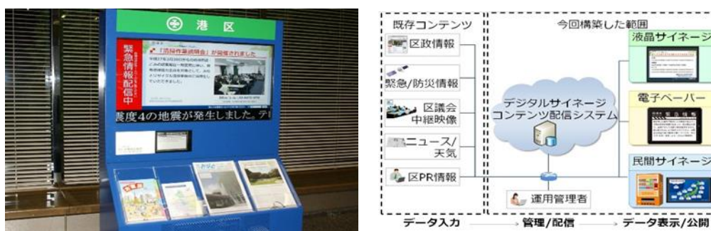
図 6-12 デジタルサイネージの例 (左：設置イメージ、右：システムの全体イメージ)
