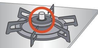
センサーが鍋底の温度を感知し、約250°Cになると自動的に消火して油の発火を防ぎます。
