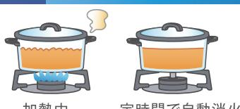
消し忘れて、点火後一定時間が経過した時点で自動消火します。
