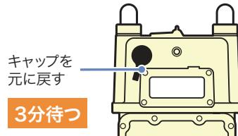
\*3分経過後も、赤ランプが点滅し、ガスが止まったままの時は、ガス栓の閉め忘れやガス機器の止め忘れがないか、再度確認してください。止め忘れがあった場合は、止めていただき、もう一度上記
