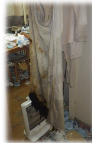
電気ストーブに洗濯物が接触し焼損した状況
