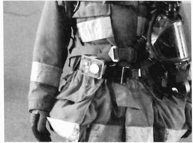
写真5 高性能警報器の装着状況
