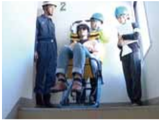
階段避難器具 階段を降りて避難させることができます。
