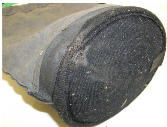
写真2 焼損したレンズポーチ
