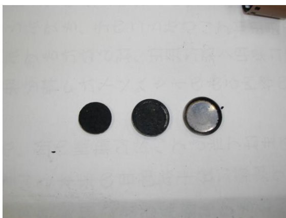
写真1 出火したコイン形リチウム電池
