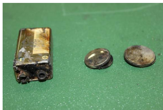
写真4 出火したコイン形リチウム電池と角型電池
