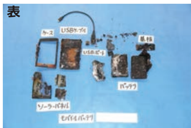
写真 6-6-4 モバイルバッテリーの焼損状況
