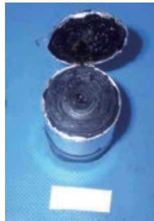
写真6-1-5 コンデンサの焼損状況
