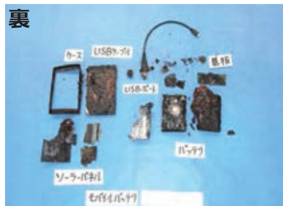
写真 6-6-5 モバイルバッテリーの焼損状況
