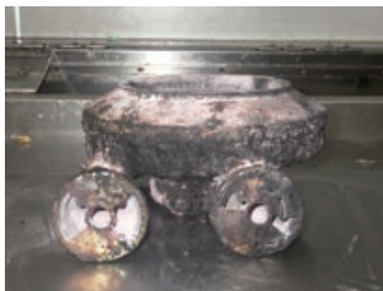
写真 6-3-3 油かすの焼損状況
