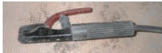
写真 5-2-4 電気溶接器の状況
