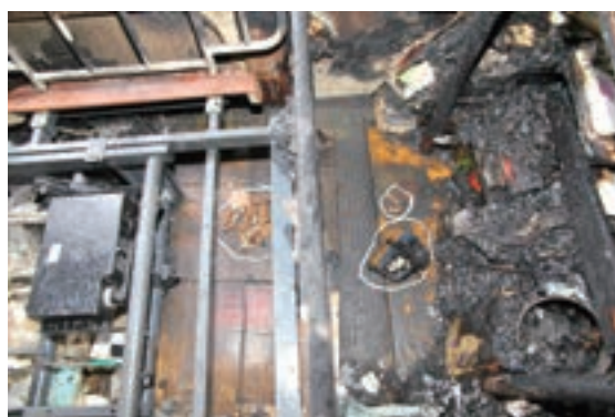
写真 4-2 ベッド周辺の吸い殻の状況
