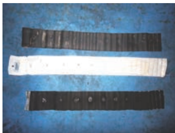
写真 6-1-7 セパレータ、正極、負極を展開した状況
