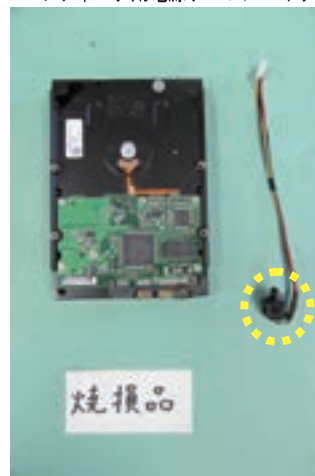
写真3-5-2 ハードディスク用電源ケーブルコネクタの焼損状況
