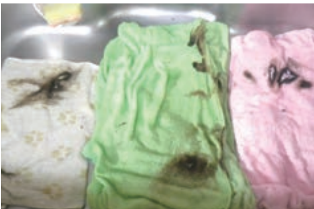
写真 3-3-4 焼損したタオルの状況
