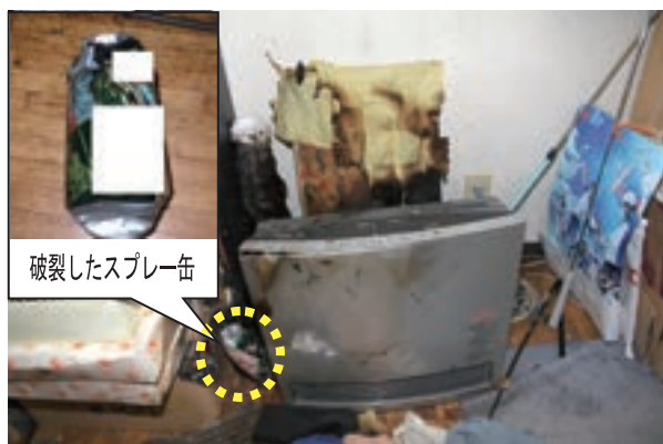
写真3-4-1 ガスファンヒータ周辺の状況
