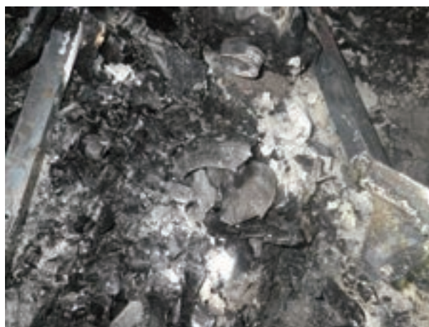
写真 6-9-6 割れたガラス製灰皿の状況
