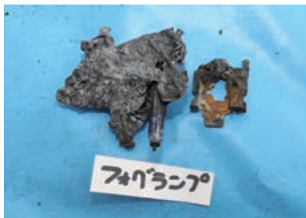
写真 6-13-3 左フォグランプの焼損状況
