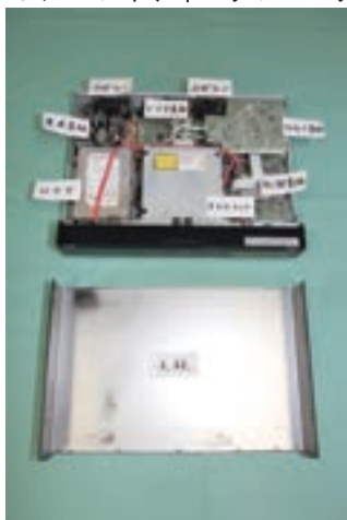
写真3-5-1 ブルーレイディスクレコーダの焼損状況
