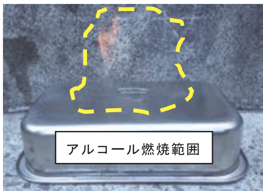
写真 2-8-1 アルコール燃焼状況（明るい場所） 写真 2-8-2 アルコール燃焼状況（暗い場所）
