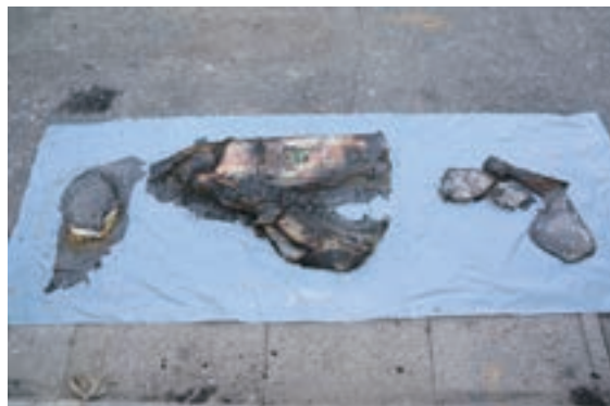
写真 2-2-4 焼損した布団の状況
