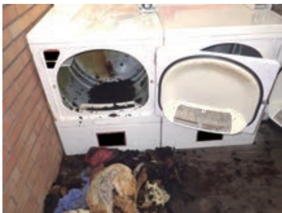
写真 3-2-3 乾燥機及びタオルの焼損状況
