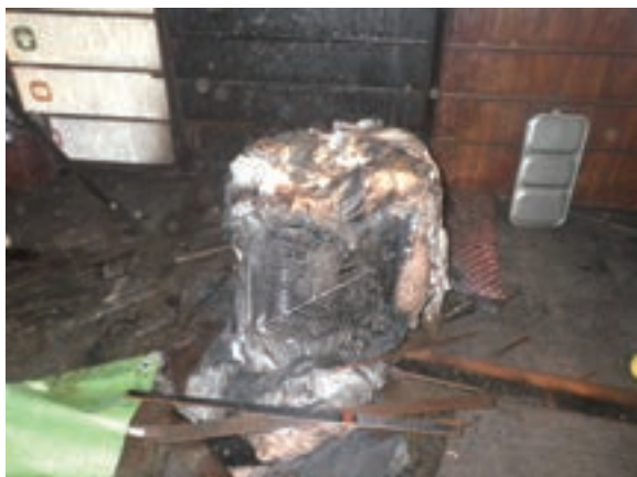
写真 5-1-3 石油ストーブの焼損状況
