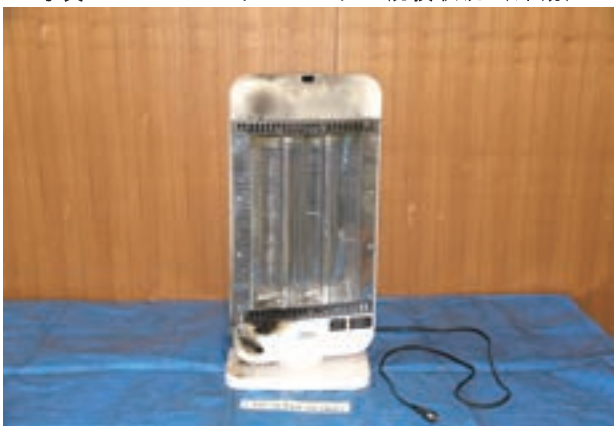
写真 3-5-3 カーボンヒータの焼損状況（外観）
