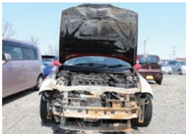
写真 6-13-2 車両前方灯火装置の焼損状況
